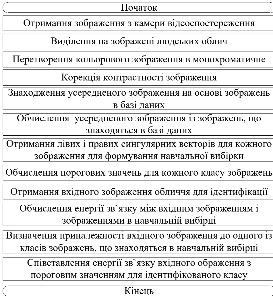
Рис. 1. Схема алгоритму ідентифікації людини по зображенню обличчя
